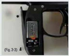
Hinweis: Einige wiederaufladbare Batterien sind zu groß für die MINI GS. Wenn sie nicht in das Batteriefach passen sollten sie bitte nicht mit Gewalt eingesetzt werden, da dies das Board beschädigen könnte.
