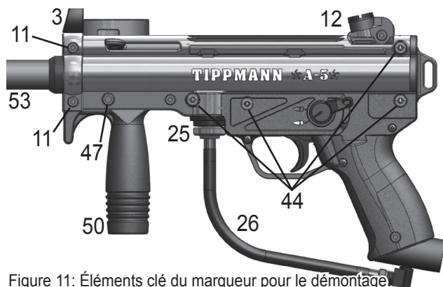
Figure 11: Éléments clé du marqueur pour le démontage.
