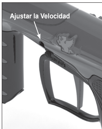
Figura 3: Use una llave Allen de 3/16" para ajustar la velocidad.
