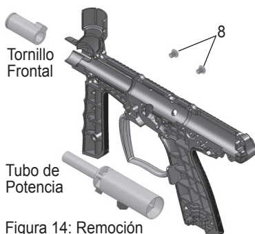
Figura 14: Remoción del Tubo de Potencia
