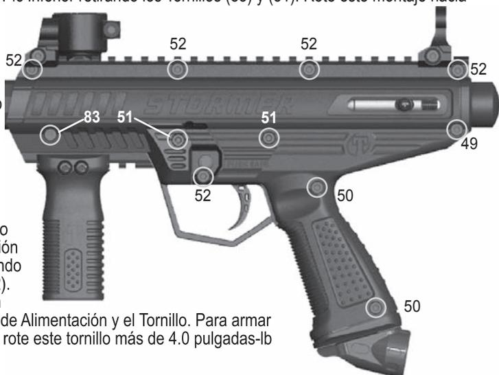
5. Retire el Codo de Alimentación (77) removiendo el Tornillo (52). Coloque a un lado el Codo de Alimentación y el Tornillo. Para armar de nuevo, no rote este tornillo más de 4.0 pulgadas-lb (0.45 N-m).
